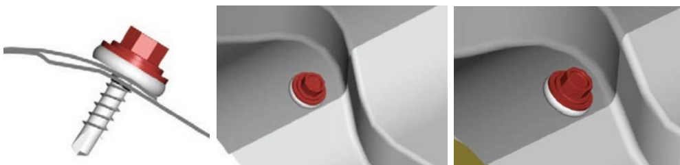
Slika 48 Pravilno učvršćivanje vijcima
