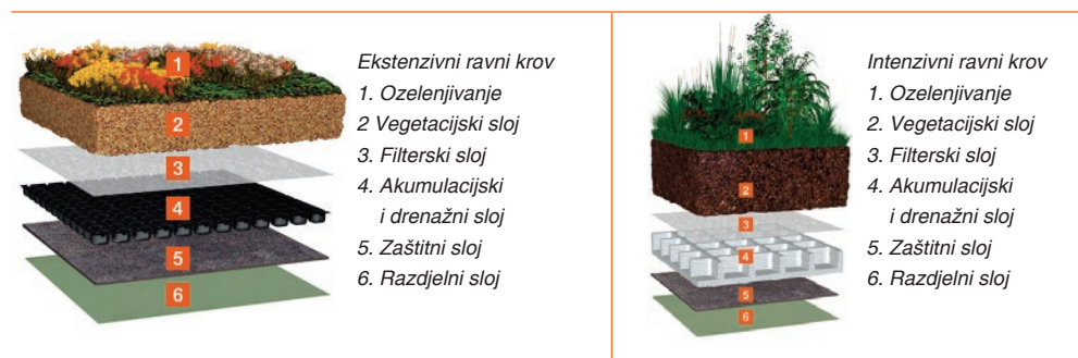
Slika 86 Detalj zelenog krova izvedenog na betonskoj konstrukciji ravnog krova, slojevi iznad razine toplinske izolacije (ostali slojevi kao kod klasičnog ravnog krova; ekstenzivni (lijevo), intenzivni (desno))
