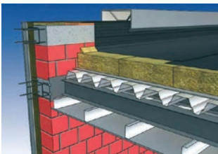
Slika 76 Neprohodni ravni krov
