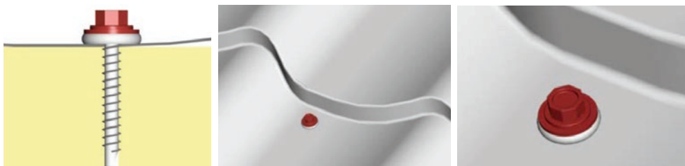
Slika 48 Pravilno učvršćivanje vijcima
