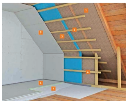
Slika 101 Obloga potkrovlja na drvenoj potkonstrukciji
