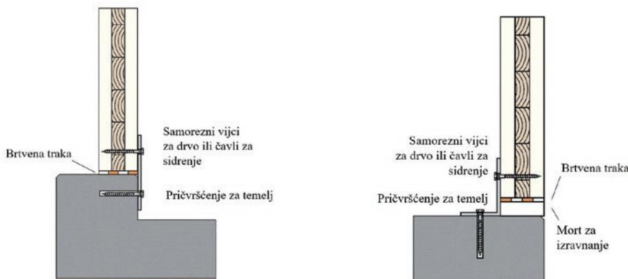
**Slika 33** Spoj zidne križno lamelirane ploče i podnožja zgrade, mogućnost izvedbe s vanjske i unutarnje strane
