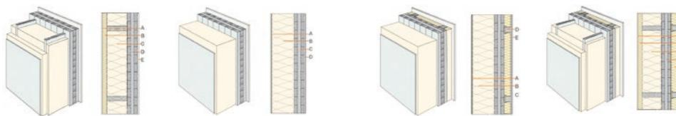
*Slika 39* Primjeri izvedbe **dodatne toplinske izolacije vanjskih zidova** s kontaktnom fasadom s vanjske strane
