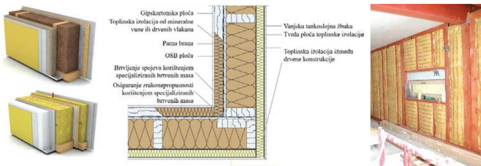
**Slika 47** Primjeri toplinske izolacije okvirnih drvenih zidova
