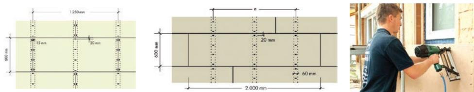
**Slika 51** Prikaz rasporeda pričvršćenja ploča toplinske izolacije od drvenih vlakana za drvenu potkonstrukciju kod klamanja
