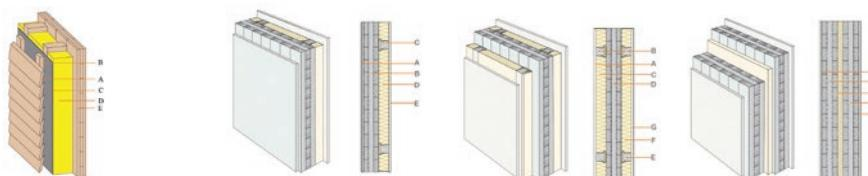
*Primjer izvedbe **dodatne toplinske izolacije vanjskih zidova** s ventiliranom fasadom*
