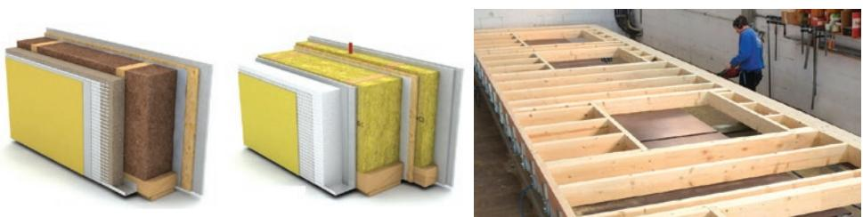
*Slika 16 Moguća rješenja toplinske izolacije montažnih zidova, izrada zidova u tvornici*
