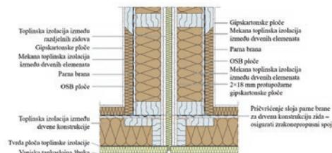
**Slika 67** Detalj spajanja razdjelnog zida požarnih sektora i vanjskog zida drvene zgrade
