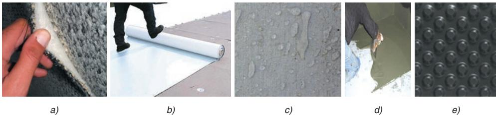
**Slika 20** a) Bentonitna HI; b) HI od sintetske gume; c) vodooodbojni premazi; d) polimer cementni premaz; e) zaštita čepastom folijom
