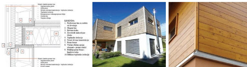
*Slika 65* Prijelaz s ventilirane na kontaktnu fasadu
