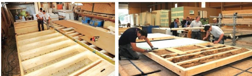
*Slika 40* Primjer proizvodnje drvenih okvirnih panela u tvornici
