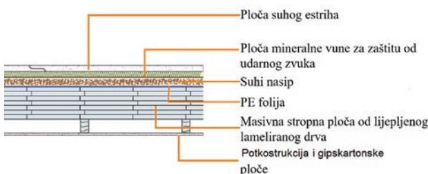
*Slika 70 Drveni strop s masivnom stropnom pločom od lijepljenog lameliranog drva*
