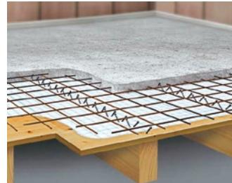
*Slika 71 Spregnuti sustav drvo-beton*
