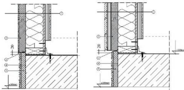
*Slika 41* Drveni okvirni zid, žbukana i ventilirana fasada
