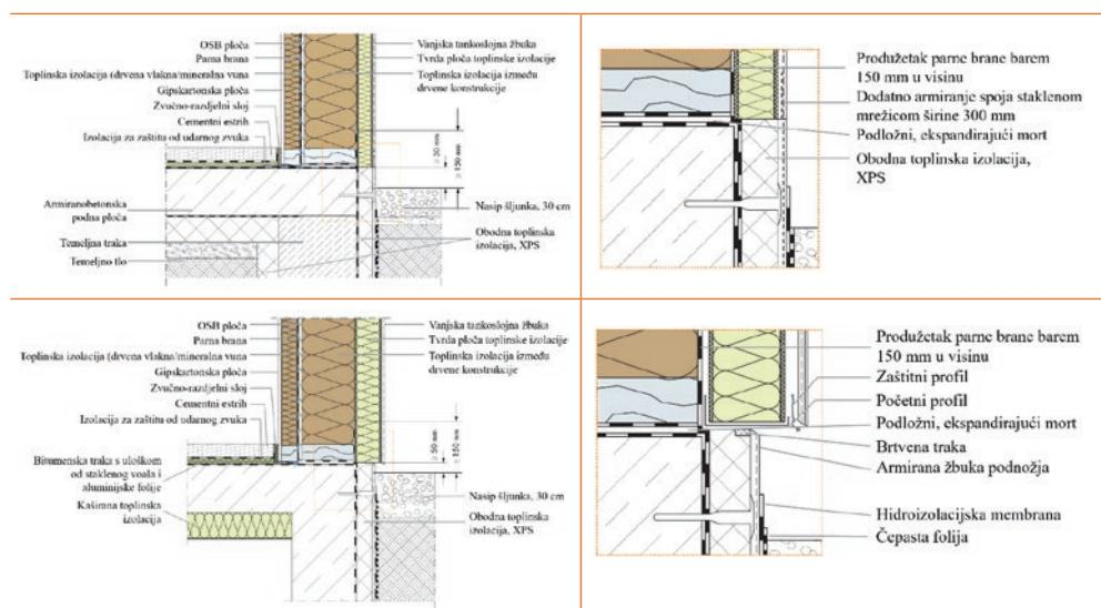
Slika 42 Primjer mogućeg rješenja spoja drvenog zida (okvirna konstrukcija) i poda na tlu (stropa negrijanog podruma)
