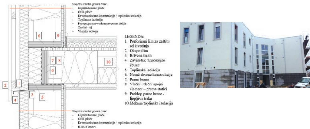
**Slika 54** Moguće rješenje vertikalnog presjeka vanjskog zida i međukatne konstrukcije bez izvođenja dilatacije ETICS-a
