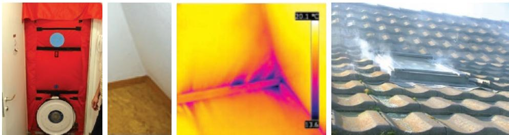
*Slika 89* Prikaz ispitivanja zrakopropusnosti drvene zgrade metodom blower door
