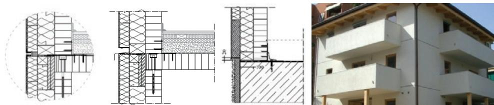
**Slika 53** Vertikalni presjek vanjskog zida/lamelirani nosač s ETICS sustavom i dilatacijskom fugom u visini stropa, odnosno poda
