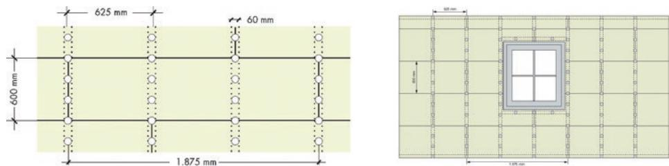
**Slika 52** Prikaz rasporeda pričvršćenja ploča toplinske izolacije od drvenih vlakana za drvenu potkonstrukciju kod korištenja vijaka za drvo s rozetom
