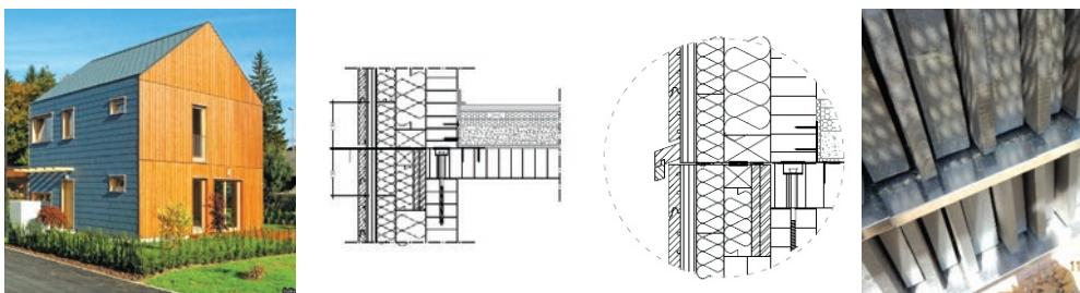
*Slika 64* Međukatni spoj s okapnicom kod ventilirane fasade s drvenom oblogom
