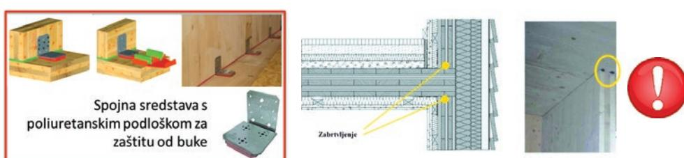
*Slika 38* Primjeri ostvarenja zaštite od buke i zrakonepropusnosti spoja
