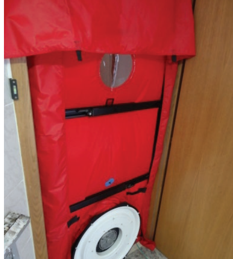
Slika 25 Uređaj za mjerenje zrakopropusnosti zgrade (BLOWER DOOR)
