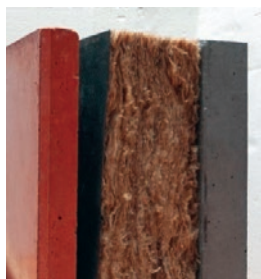
Slika 6 Građevinski otpad i ventilirani fasadni panel izrađen od recikliranog betona i opeke
