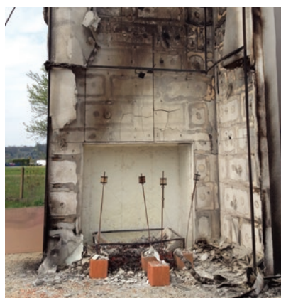
Slika 9 Uzorci (u punoj veličini h=8 m) za ispitivanje otpornosti ETICS fasada na požar, za vrijeme i nakon požara
