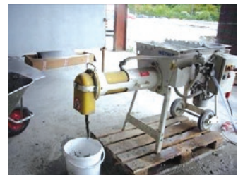
Tablica 4 Miješanje morta za armaturni sloj: a) električna miješalica; b) horizontalna miješalica
