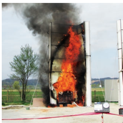
Slika 9 Uzorci (u punoj veličini h=8 m) za ispitivanje otpornosti ETICS fasada na požar, za vrijeme i nakon požara
