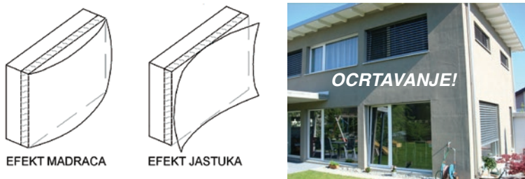
Slika 10 Deformacije kod toplinsko-izolacijskih materijala, shematski
