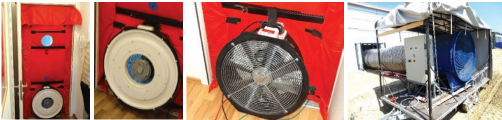
Slika 18 Sustav za ispitivanje zrakopropusnosti vanjske ovojnice zgrade, za zgrade malih i velikih volumena
