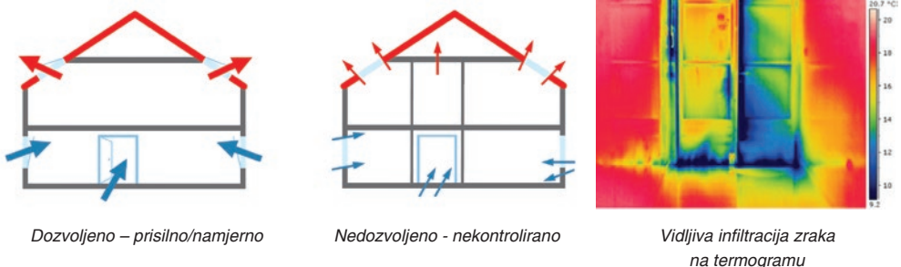
Slika 24 Dozvoljene –nedozvoljene izmjene zraka; otkrivena izmjena zraka IC termografijom
