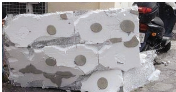
Slika 47 Neadekvatno ugrađen ETICS sustav, Vukovar, svibanj 2010.
