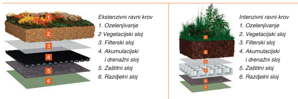
Slika 57 Detalj zelenog krova izvedenog na betonskoj konstrukciji ravnog krova, slojevi iznad razine toplinske izolacije (ostali slojevi kao kod klasičnog ravnog krova; ekstenzivni (lijevo), intenzivni (desno))
