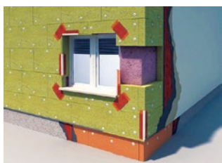
Izvedba topl. sustava fasade
