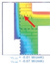
Raspodjela temperature u presjeku s i bez „toplinske pете“
