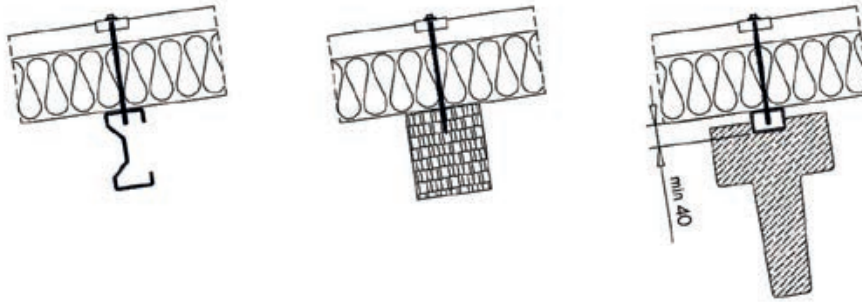
Slika 3-88 Ugradnja panela na nosače [252]
