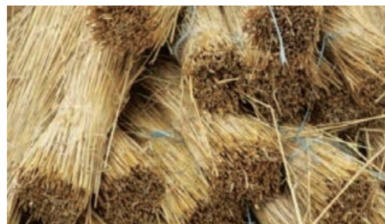
Slika 5-3 Snopovi slame pripremljeni za ugradnju [305]
