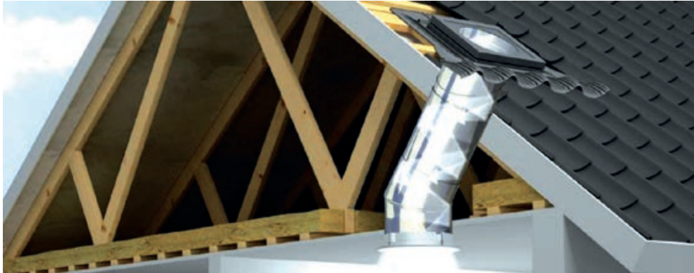
Slika 1-177 Primjer funkcioniranja svjetlosnog tunela [135]
