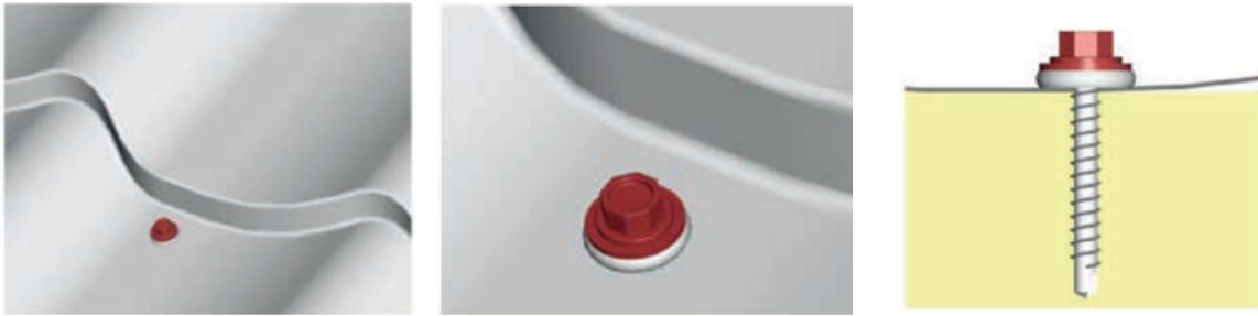
Slika 3-56 Ugradnja krovnih limenih ploča [237]
