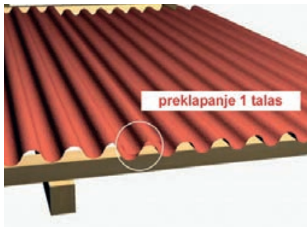
Slika 4-24 Preklapanje 1 val ploča pri izvedbi pokrova [273]
