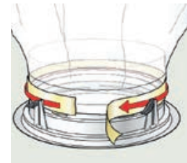
Brtvljenje parne brane za opšav stropne jedinice
