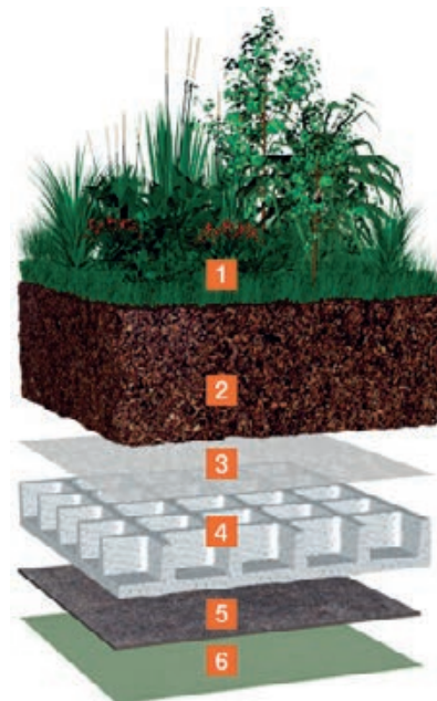
Slika 6-31 Primjeri slojeva ekstenzivnog i intenzivnog ravnog krova [347]
