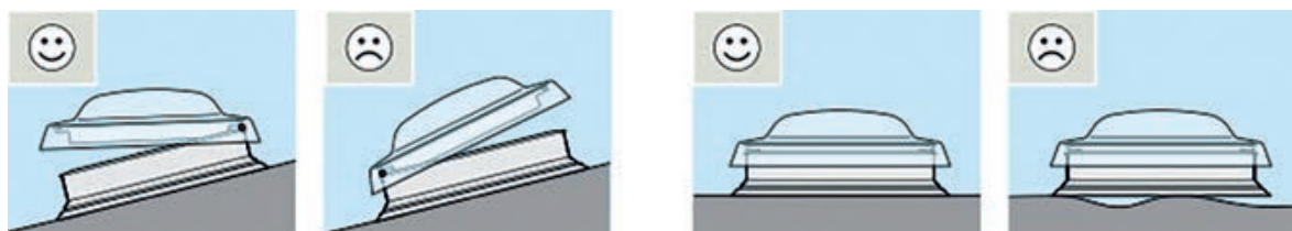
Slika 1-186 Postavljanje prozora za ravni krov [135]
