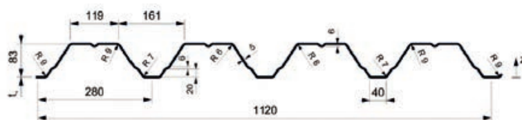
Slika 3-25 Tehnički podaci za čelični profilirani lim [223]
