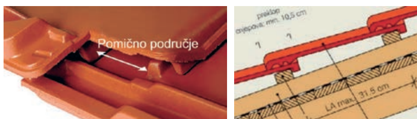
Slika 2-61 Mogući pomak crijeva [187], [23]
