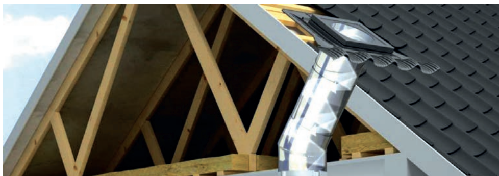
Slika 2-108 Primjer funkcioniranja svjetlosnog tunela [143]
