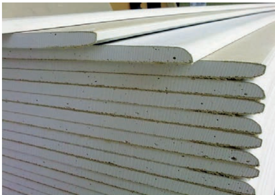
Slika 1-38 Presjek gipskartonskih ploča [37]
