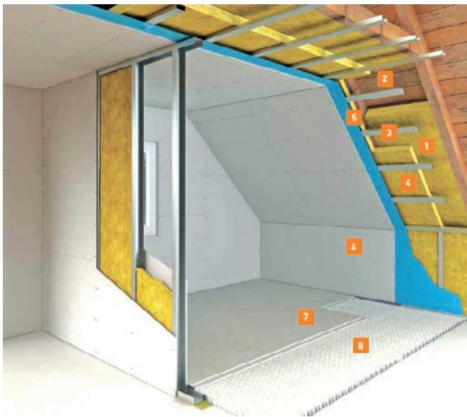
Slika 2-99 Obloga potkrovlja na metalnoj potkonstrukciji [91]
