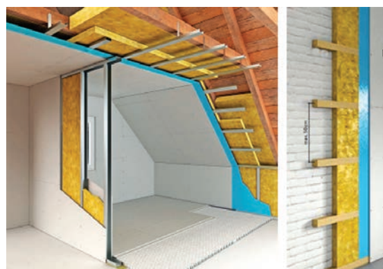
Slika 2-2 Zidni sustavi suhomontažne gradnje [83], [84]
