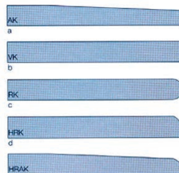
Slika 1-39 Različite izvedbe rubnih završetaka gipskartonskih ploča [38]
