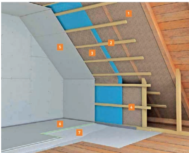
Slika 2-98 Obloga potkrovlja na drvenoj potkonstrukciji [91]
