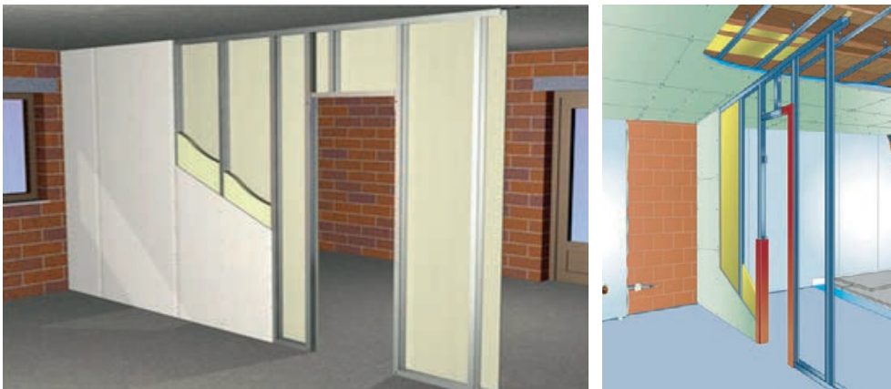
Slika 2-52 Vrata u pregradnom zidu [114], [99]
