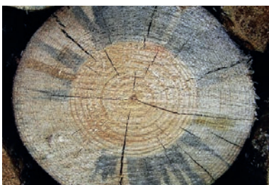
Slika 4-22 Gljivično plavljenje drva [182]
