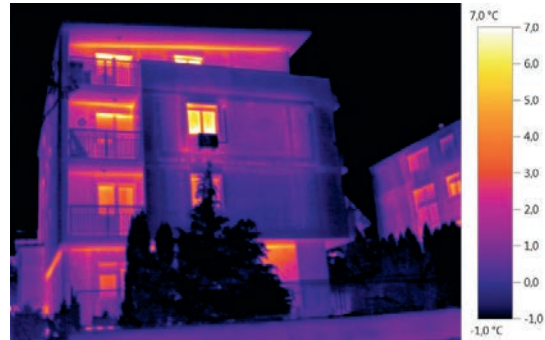
Slika 2-110 Gubici topline kroz otvore [145]
