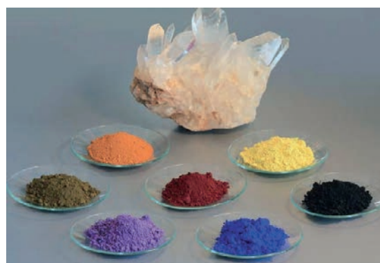
Slika 1-64 Kristal kvarca i praškasti anorganski pigmenti [10]
