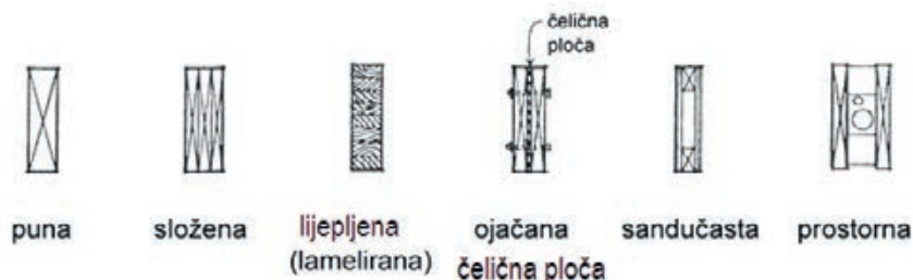
Slika 2-33 Oblici drvenih greda za skeletnu konstrukciju [178]
