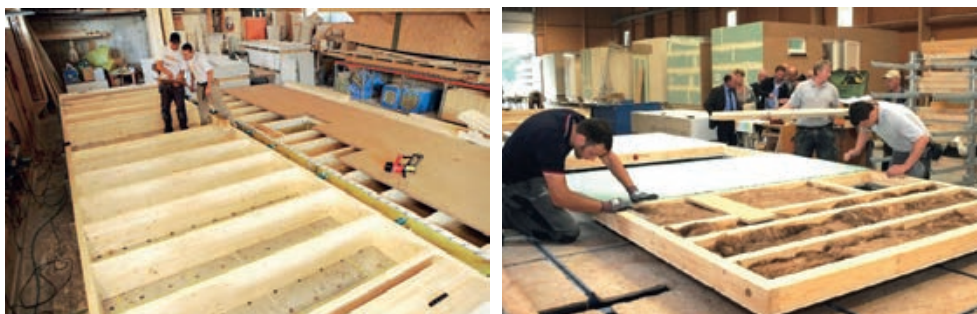
Slika 2-89 Primjer proizvodnje drvenih okvirnih panela u tvornici [212], [213]
