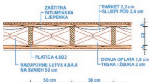
Slika 3-112 Drveni strop od platica [192]
