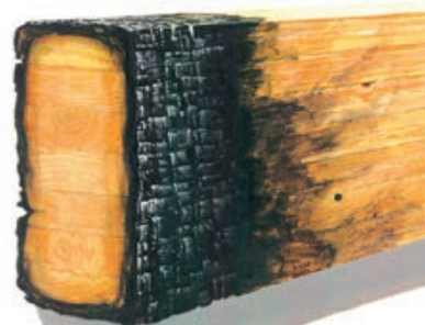
Slika 2-1 Primjer opožarenog presjeka grede od lijepljenog lameliranog drva [144]
