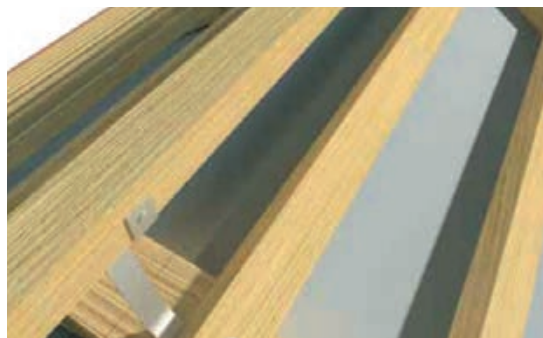
Slika 3-183 Prva opcija: letva sljemenjaka – montaža na nosač [335]
