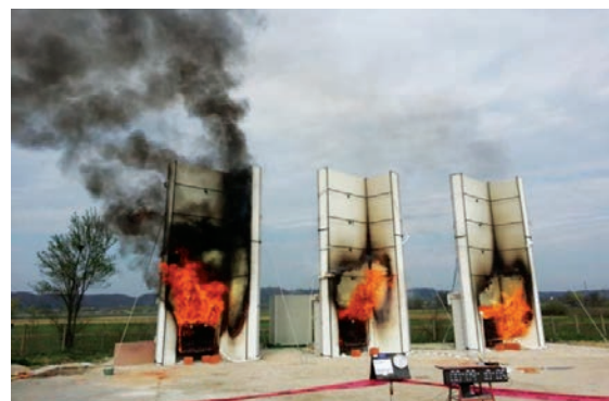
Slika 3-18 Ponašanje tri ETICS sustava tijekom požara [11]
