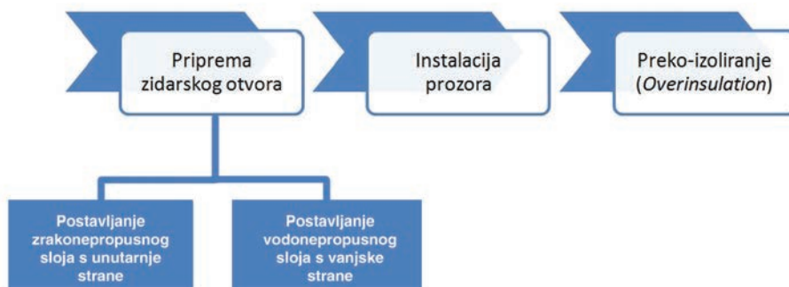
Slika 5-27 Postupak pravilne ugradnje prozora
