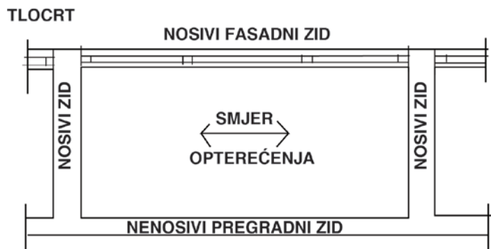
Slika 4-50 Nosivi i nenosivi zidovi
