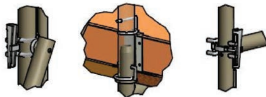
Slika 4-146 Tipovi vezanja pojedinih elemenata skele
