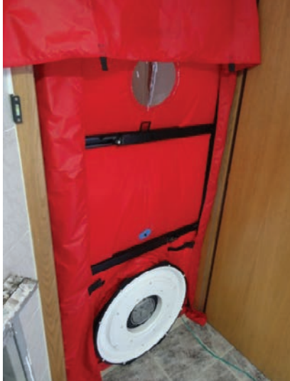
Slika 5-3 Ispitivanje zrakonepropusnosti zgrade, uređaj „Blower door“ [11]
