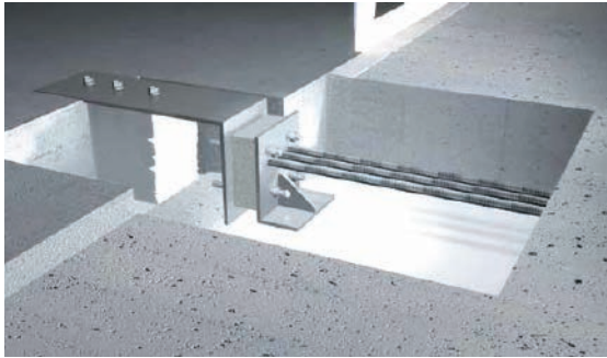
Slika 4-127 Predgotovljeni AB balkon ugrađen na postojeću AB stropnu ploču [130]
