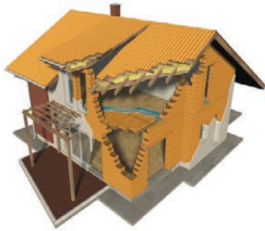
Slika 4-33 Masivni konstrukcijski sustav [80]
