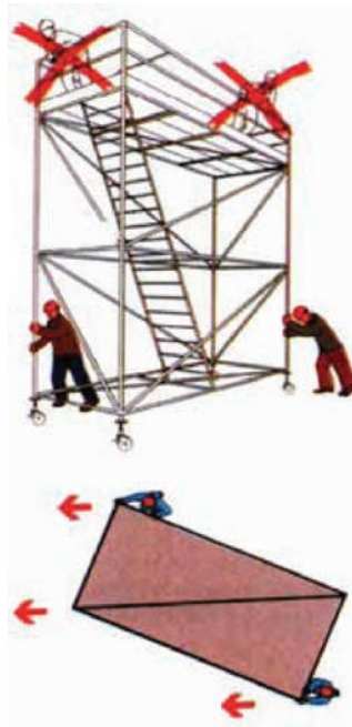
Slika 4-164 Na pomičnoj skeli prilikom postavljanja radnici moraju biti vezani
