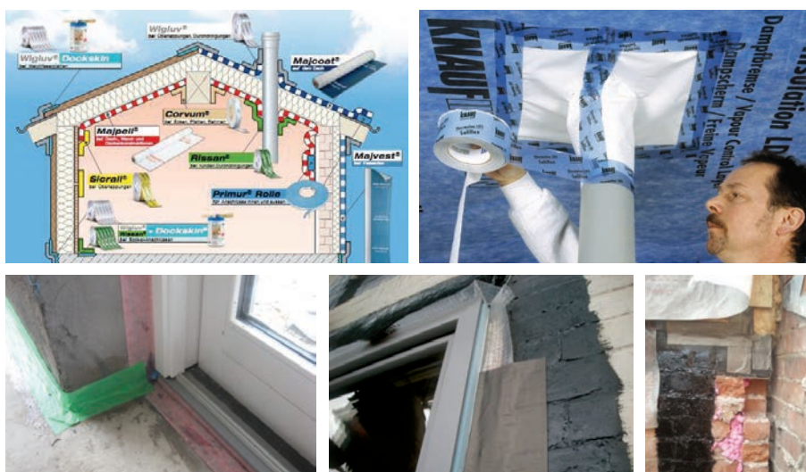
Slika 5-15 Proizvodi za postizanje zrakonepropusnosti vanjske ovojnice zgrade [164]
