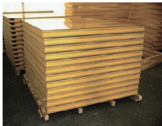
Slika 3-216 GAP solarni elementi prije ugradnje u predgotovljene drvene zidne panele [196]
