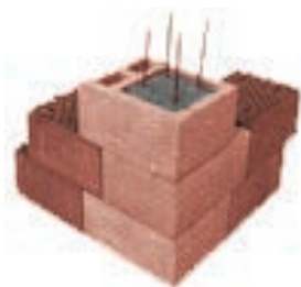
Slika 1-95 Blokovi za okomiti serklaž opekarskih zidova
