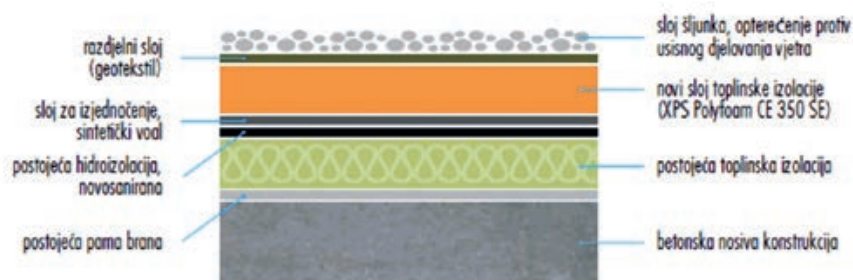
Raspored slojeva kod duo - krova
