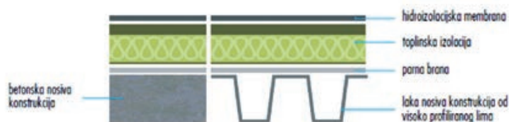
Slika 3-237 Raspored slojeva kod klasičnog toplog ravnog krova [205]
