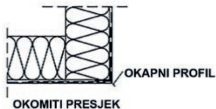
Slika 3-118 Oblikovanje okapnog ruba [72], [134]
