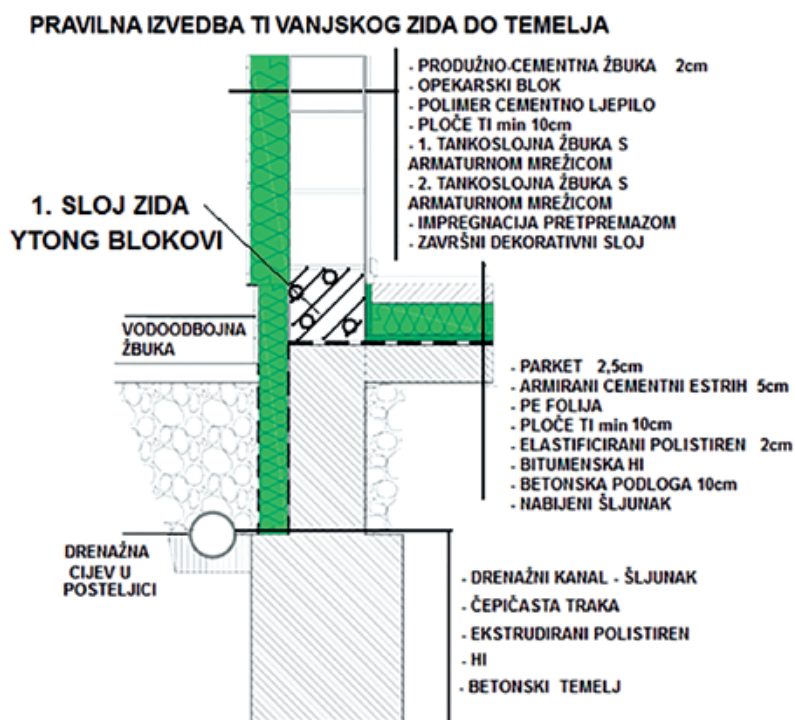
Slika 3-47 Detalj TI i HI temelja (presjek)[105]
