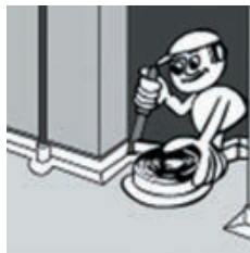
Slika 3-52 Postava rubne izolacije [106]
