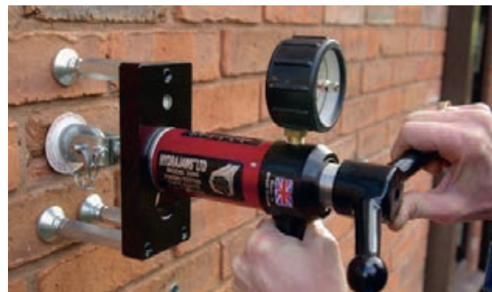
Slika 3-183 Ispitivanje čvrstoće prionjivosti postojećeg zida korištenjem metode pull-off [56][181]
