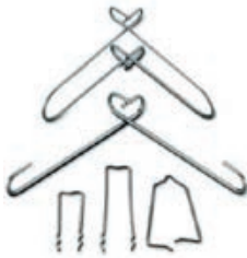
Slika 3-180 Vezni elementi, žičani vezni elementi [181]
